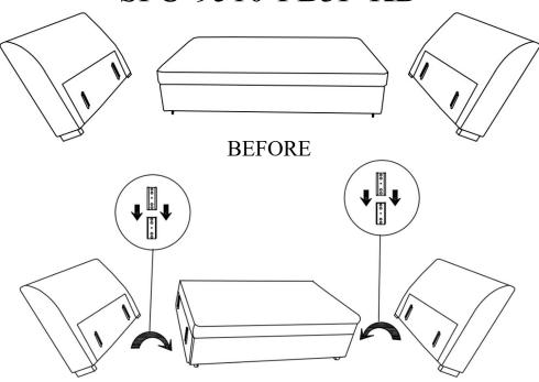
INSERT THE LEFT/RIGHT ARM-PLUG INTO BODY-PLUG AS SHOWN IN ABOVE FIGURE
