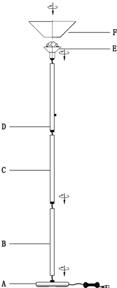
1. Atornille el poste (b) hacia la derecha sobre la base (a) hasta aprietan y unen con tornillos el poste (b), (c), (d) y Portapantalla (e). Usted puede necesitar tirar de cualquier exceso de cordón suavemente a través de los postes de modo que estas dos piezas quepan.
